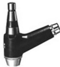
心合わせが素早く正確に行なえます。工作機械の主軸（カッタースピンドル）にセットし、接眼レンズをのぞきながら、視野内に見える指標の中心に被加工面上の基準点を合致させることにより、芯合わせが容易かつ正確に行なうことができます。
